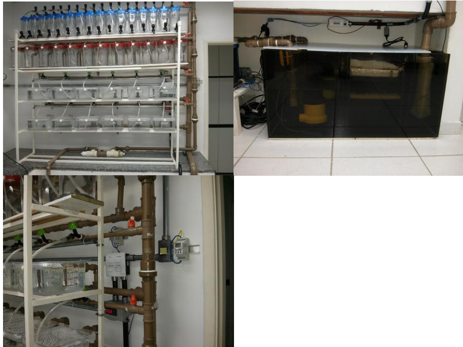
Figura 1 Vista frontal da estante e aquários posicionados; Figura 2 vista frontal do “SUMP” e seus compartimentos e Figura 3 visão lateral do sistema com torneiras de entrada, termostato e timer de controle das bombas de água (figuras em sequencia 1,2 e 3).
