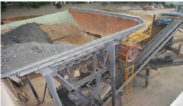
Figura 3. Vista geral do britador de mandíbulas Fonte: Dados da pesquisa
