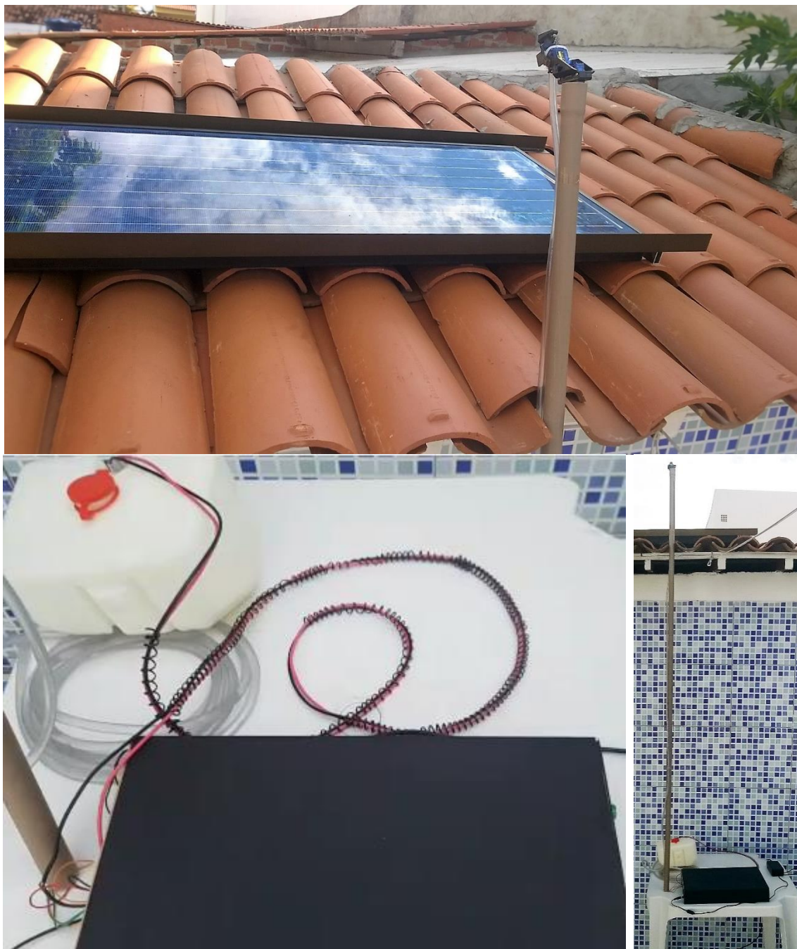
Figura 8. Montagem completa do protótipo utilizando dois servos motores (Pan Tilt).
