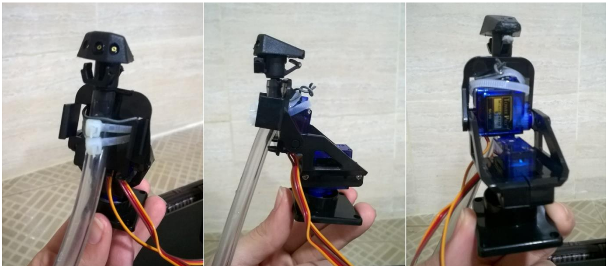
Figura 6. Bocal acoplado ao suporte Pan Tilt e mangueira.
