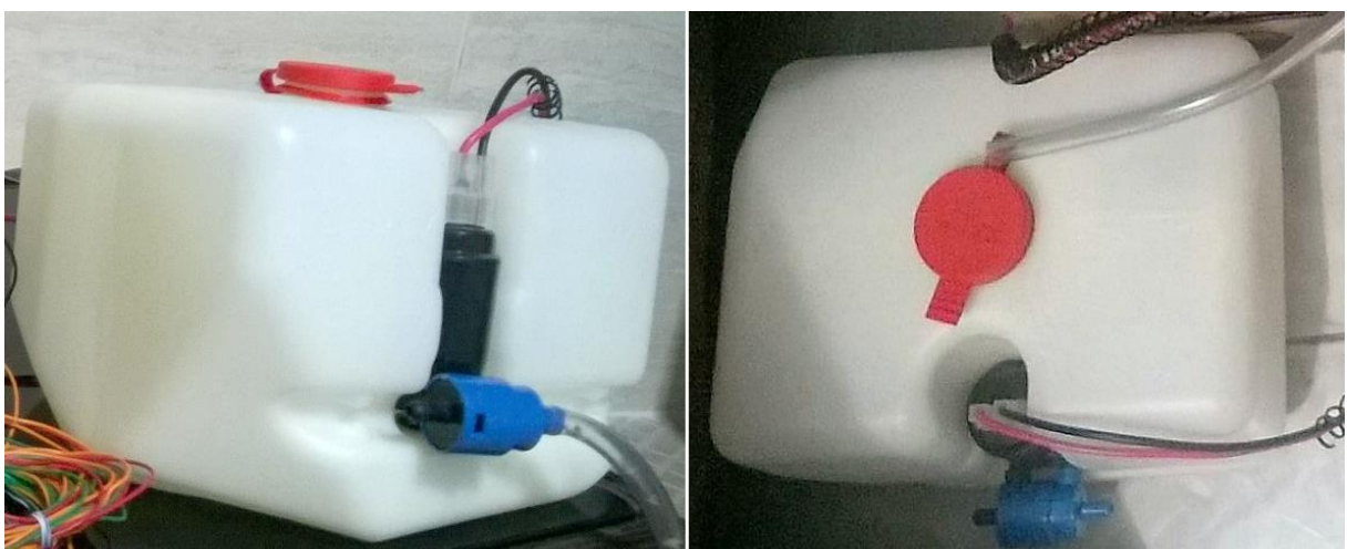
Figura 7. Reservatório de 2 litros, bomba 12V e mangueira utilizados no protótipo.
