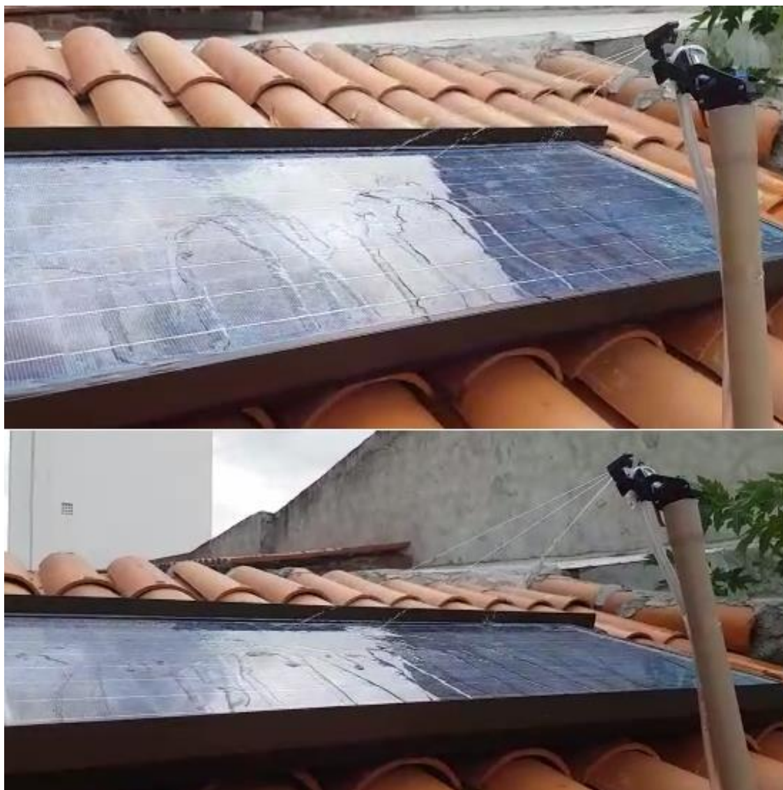
Figura 9. Funcionamento do protótipo utilizando dois servos motores (Pan Tilt).
