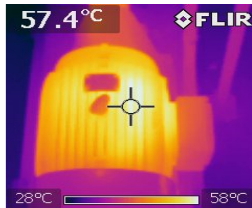
Figura 12 – Temperatura de Operação do Motor Elétrico de 25CV (Após a Otimização do Processo)
