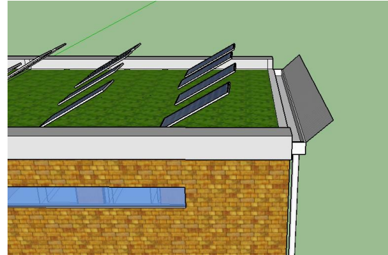
Figura 7. Ampliação da placa de auxílio de captação pluvial.
