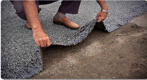
Figura 4: Asfalto Ecoflex proveniente de borracha de pneus inservíveis. Fonte: Morrilha e Greca (2003)
