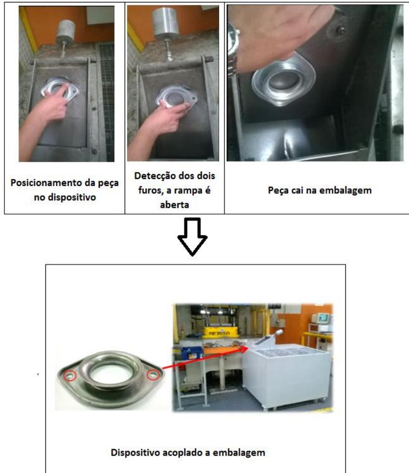
**Figura 9. Sequência de funcionamento do dispositivo e dispositivo acoplado a embalagem**
