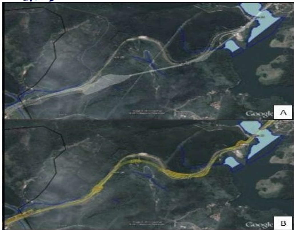
Figura 2 - Trecho da duplicação da Rodovia Tamoios - Serrinha. Em A, projeto apresentado e selecionado do trecho do km 25 ao 28 na ocasião do EIA-RIMA (Alternativa 2), interferindo em fragmento florestal em estágio avançado de regeneração. Em B, projeto aprovado na Licença Ambiental de Instalação – Prioridade 3, LI nº. 2121.
