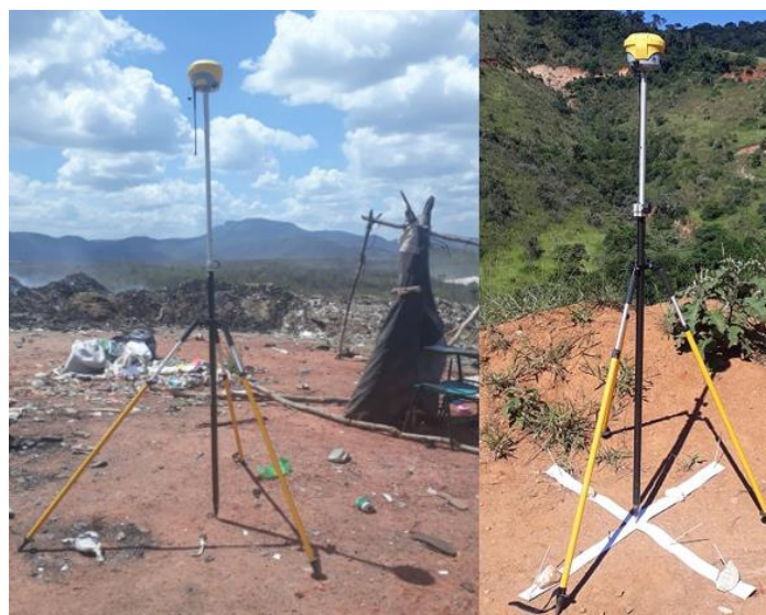
Figura 7 – Vértice Base transportado e Pontos de Apoio/Check levantado
