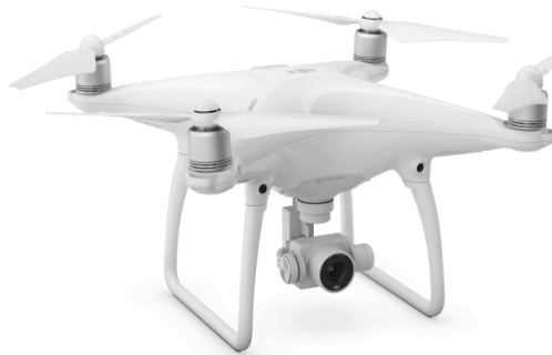
Figura 2 – Phantom 4 Advanced modelo quadricoptero utilizado no estudo
