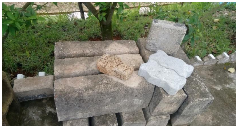
Figura 9. Material de RCC transformado em bloco pré-moldados para pavimentação.
