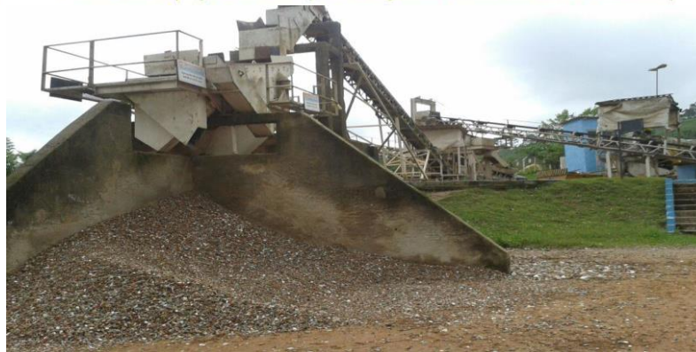
Figura 7. Material separado na máquina britador de mandíbula
